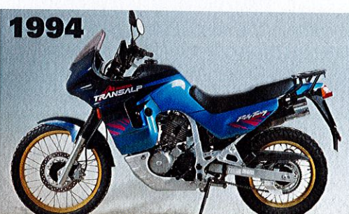
1994 XL 600 V (1994): Bauzeit: 1994–96, neue, stärker taillierte Verkleidung, neue Bremszange vorn, Hebel einstellbar, Gepäckbrücke, Preis 1994: 12.530 Mark (6406 Euro)
