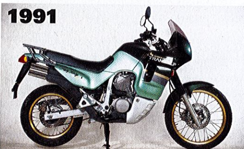
1991 XL 600 V (1991): Bauzeit: 1991–93, 240-mm-Brems Scheibe mit Einkolben-Schwimmsattel hinten, modifizierter Auspuff, Leergew.: 202 kg, Preis 1991: 10.850 Mark (5547 Euro)
