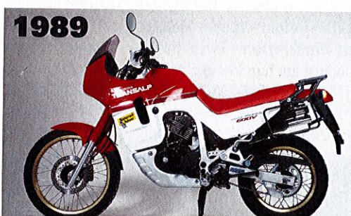
1989 XL 600 V (1989): Bauzeit: 1989–90, neues Federbein, Ventiltrieb aus XRV 650, modifiziertes Getriebe, 60 mm höherer Windschild, Preis 1989: 10.350 Mark (5291 Euro)
