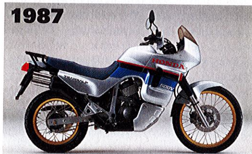
1987 XL 600 V (1987): Bauzeit: 1987–88 (Japan), PD 06, 583 cm³, 50 PS, 52 Nm, je drei Ventile, hinten Bremstrommel, Leergewicht: 200 kg, Preis 1987: 8540 Mark (4366 Euro)
